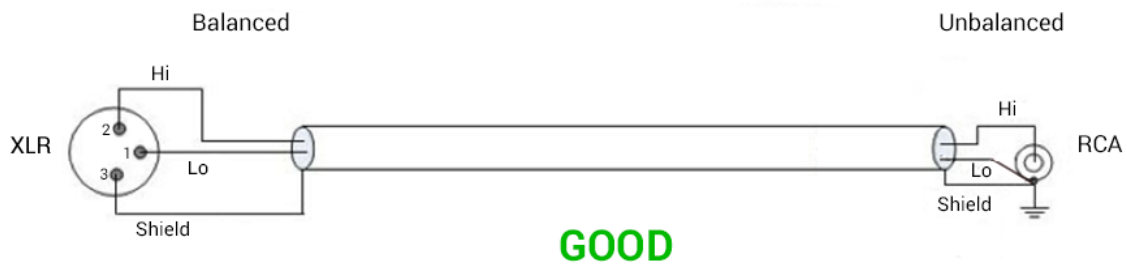
Figure 2 Anubis出力をアンバランス入力に接続する方法
