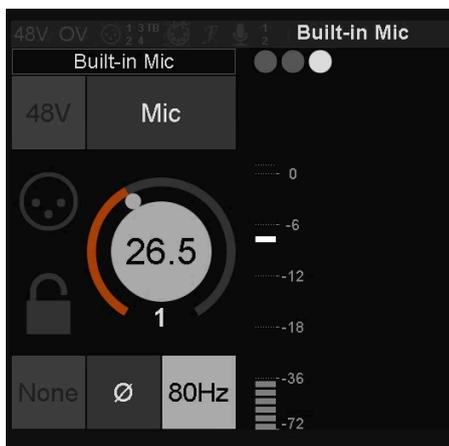
画面を一番右にスクロールさせ、Built-in Mic のページを開き、画面のゲインにタッチして Anubis のダイヤルを回して音量を調整してください。
