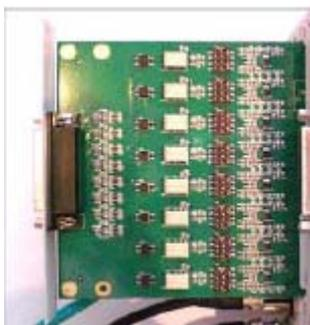
4. DIP スイッチを DA8 モジュールの基板上に印刷されている表に従って設定します。
