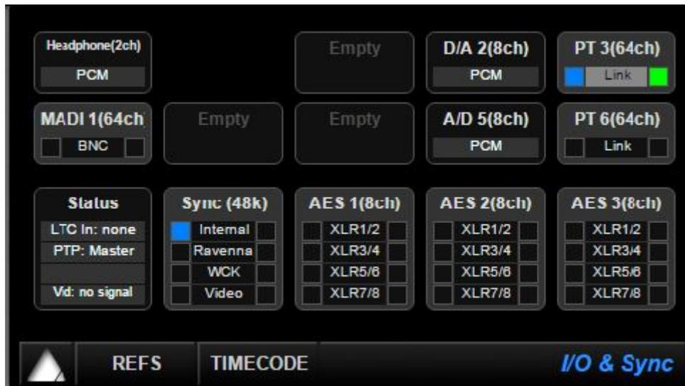
Pro Toolsでは、IOM-H-PT64モジュールでエミュレートされたデバイス（次の例ではHD MADI）のクロックソースをInternalに設定する必要があります。
