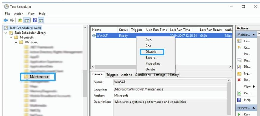
「無効」にしたい場合、下の欄にある「条件」タブで、「コンピュータがアイドル状態のときのみ起動し、アイドル状態が解除されたら停止する」ように設定してください。
