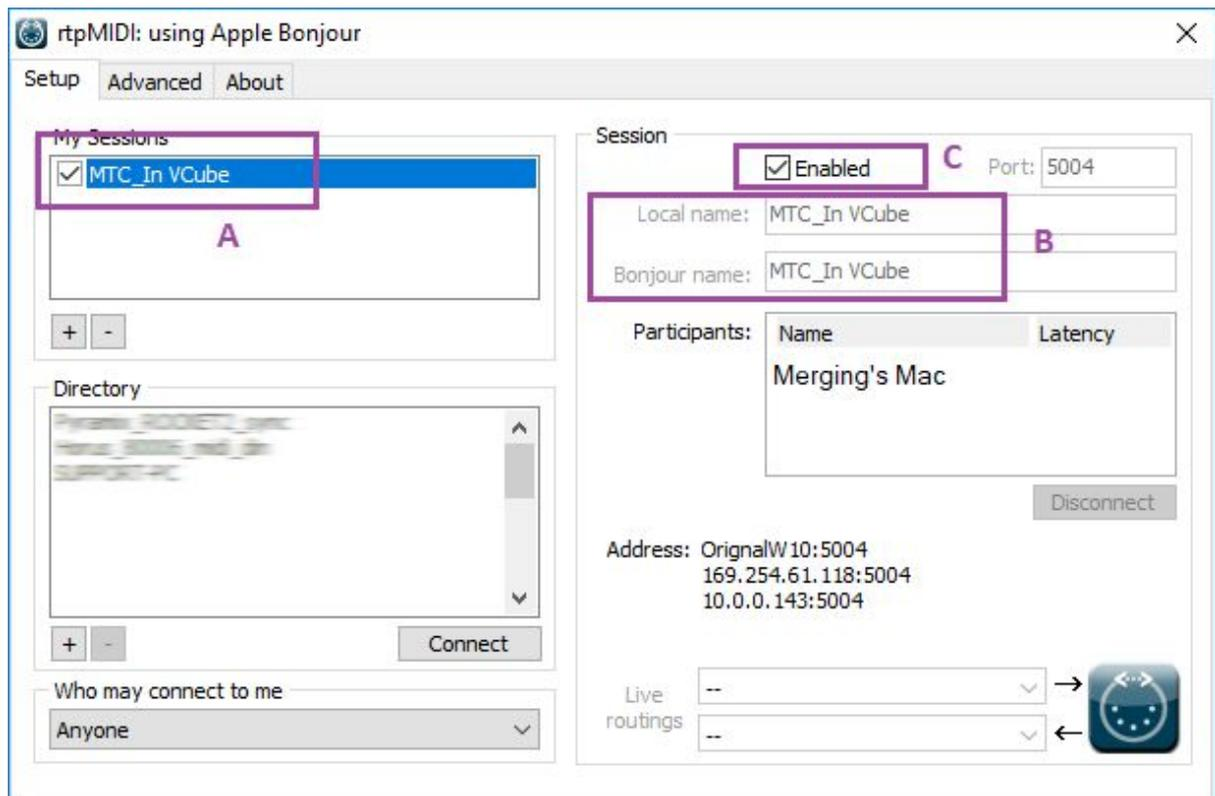
VCubeを起動し、設定 > フォーマット&シンク > MIDI Timecode Input でrtpMIFIで作成したMIDIセッションを選択します。
