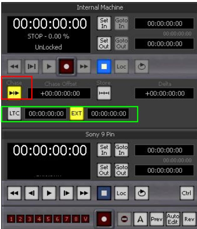
上側が Vcube のトランスポート、下側が外部機器のリモートパネルです。
