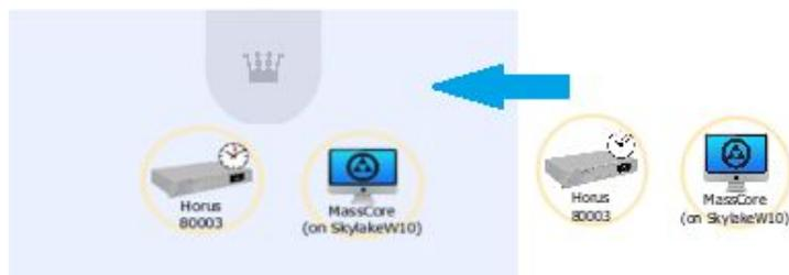
次にマスターとなるデバイスを選択する必要があります。シンプルな設定ではコンピュータを選択します。Sampling Rate zoneの上部にある王冠アイコンの上にドラッグすると、色が緑に変わりマスターデバイスとして表示されます。
