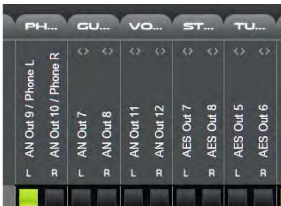
同様の事がRoutes(またはDestinations)にも当てはまり、背面パネルのどの物理出力にもアサインできます。しかしSpeaker SetのアサインはStudio Setupタブでのみ行うことができます。Headphone出力も同様で、Monitoring ControllerタブではOutputs #9-10のenable/disableのみが可能です。
