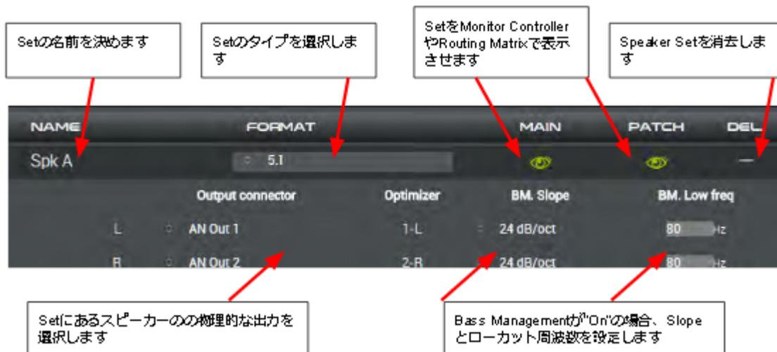
最初のSpeaker Setを作成するステップは、直感的で分かり易くなっています。また、D-Monには同じスピーカーで別のSpeaker Setを作成するなど、新しい機能があります。デフォルトではD-Monのモデルによって1つのSpeaker Setが予め組み込まれています(D-Mon|4 = Stereo, D-Mon|6 = 5.1, D-Mon|8 = 7.1)。
