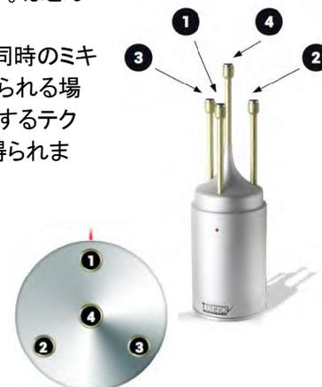
調整用マイクはリスニング ポジションに置き、リスナーの耳の高さとカプセル#4の高さが同じとなるようにセットしてください。赤いLEDインジケータは3D-マイクの前面となりますので、前面のセンターに向けてください。カプセル#1と#4を仮想の線で結び軸が対象となるよう調整してください。3D-マイクは完全に安定し、きちんと水平になっている必要があります。
