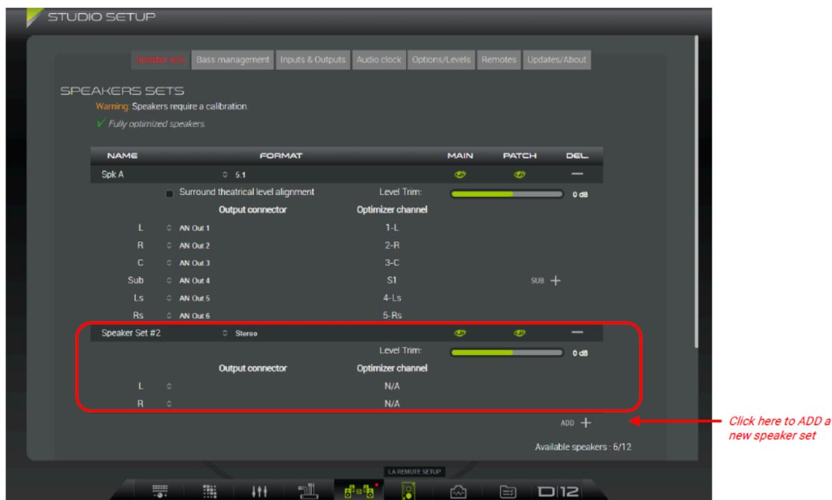
最適化された Speaker Set の数は、D-Monプロセッサーがサポートする Optimizer® のチャンネル数によって制限されます。残りのチャンネル数は、ADD + ボタンの下に表示されます。この例の Available speakers: 4/12 は、D-Mon|12で利用可能な12チャンネルのうち、モノラル Optimizer チャンネルが残り4つであることを意味します。
