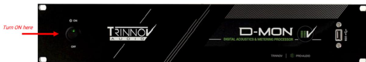
内蔵リレーのクリック音が聞こえ、上図のようにONボタンが点灯します。プロセッサの起動に数秒かかりますので、しばらく待ってからGUIを開いてください。
