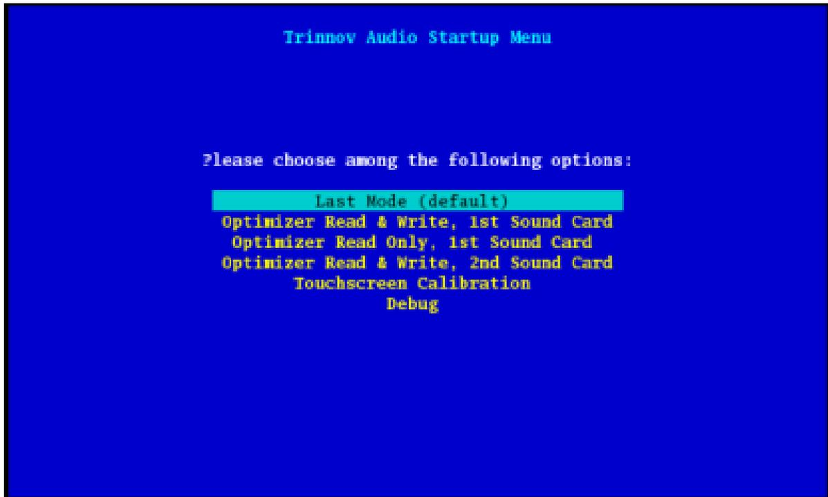
キーボードをユニットに接続すると、システムの起動時にプロセッサの設定を行うことができます。設定が選択されると、次回以降の起動時の新しいデフォルト設定となります。つまりデフォルトでは、プロセッサは前回の起動時に使用された起動オプションを使用して起動します。
